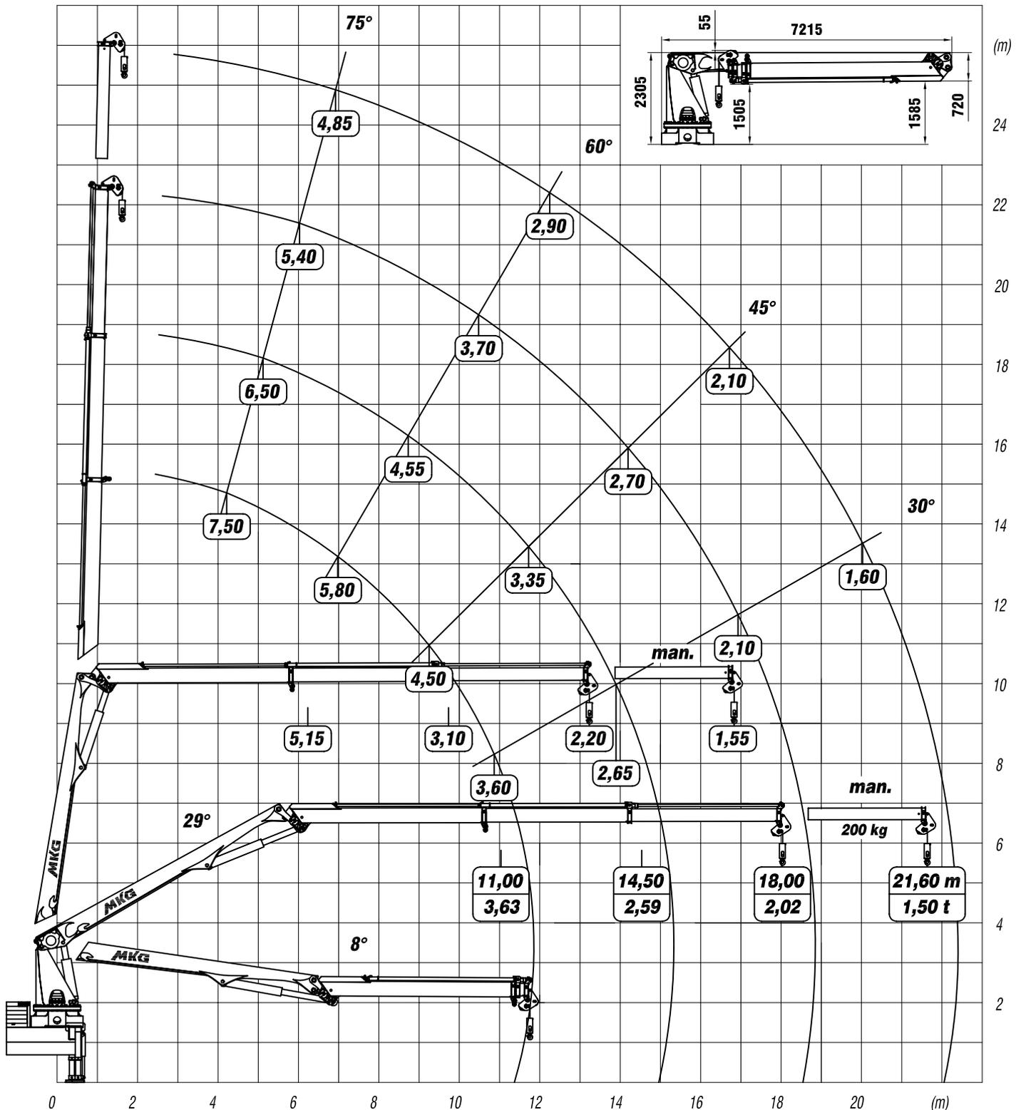
angegebene Tragwerte gelten für Windenbetrieb
